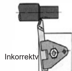
Verktget kläms i vinkel med avseende på matningsriktningen
