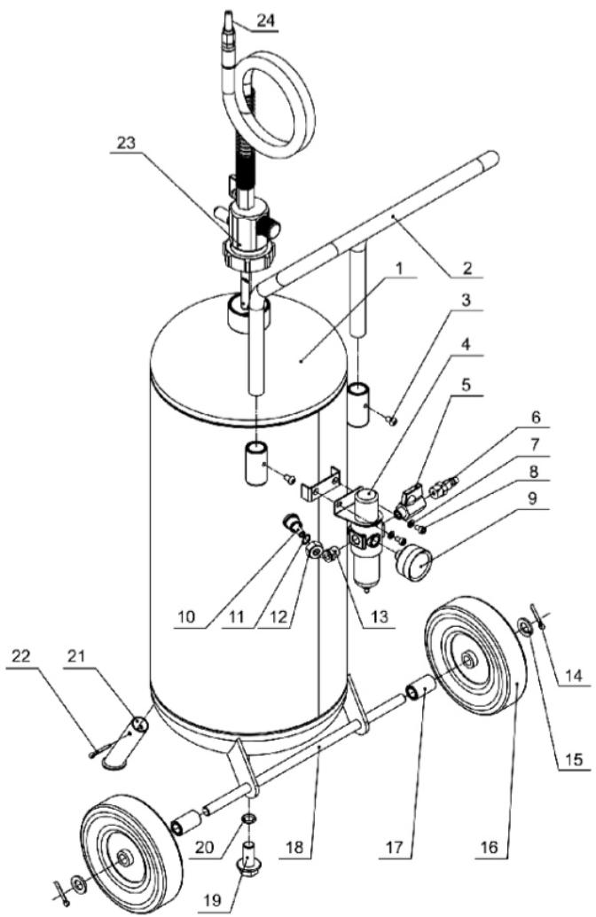
5. vaihe: Kytke säädin (23) säiliöön (1).
