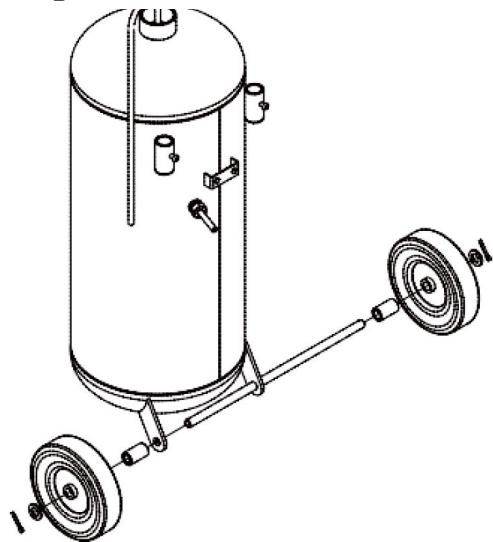
Steg 1: Montera hjul, skruv och saxsprintar. #16, #15 och #14.
