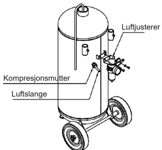
Trinn 3: Koble luftjusteringen (#4) til tanken (#1) med M5-skruen (#8). Stram med en skiftenøkkel. Koble luftslangen (#10) til tanken (#1) med tetningen (#11) og kompresjonsmutteren (#12).
