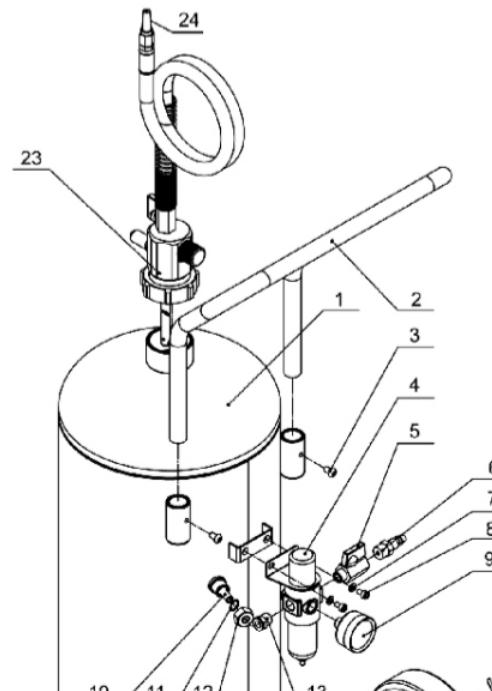
Trinn 4: Monter håndtaket (#2) til tanken (#1) med skruen (#3).
