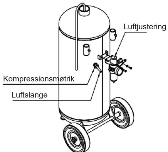
Trin 3: Slut luftjusteringen (# 4) til tanken (# 1) ved hjælp af M5-skruen (# 8), spænd med en skruenøgle. Slut luftslange (# 10) til tanken (# 1) med tætning (# 11) og kompressionsmøtrik (# 12).
