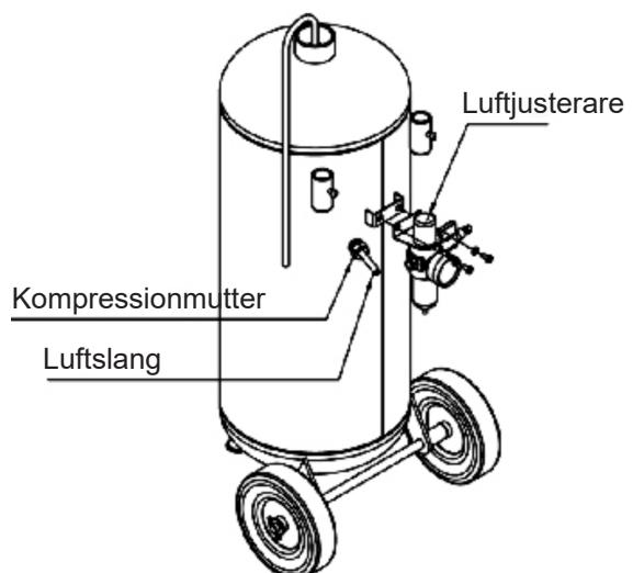
Steg 3: Anslut luftjusterare (#4) till tanken (#1) med hjälp av M5 skruv (#8), dra åt med skiftnyckel. Anslut luftslang (#10) till tanken (#1) med tätning (#11) och kompressionsmutter (#12).
