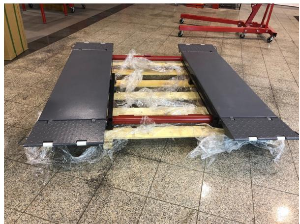
Var noga och försiktig så att kablar inte skadas. Börja därför alltid med att frigöra el kablaget genom att klippa buntbanden det sitter fast med under läppen på lyftrampen.
