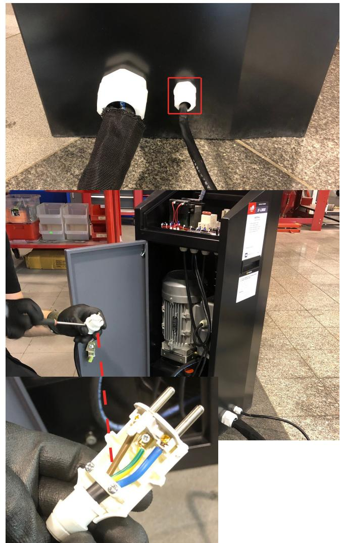
Koppla in gränslägesbrytarna (i den högra dragavlastaren till båda) och inkommade 240 volt enligt bilden
