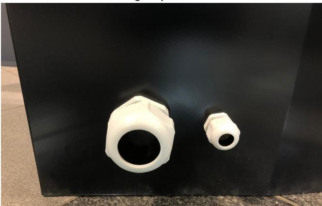
**Tip:** Du kan gøre det nemmere at trække de elektriske kabler gennem muffen ved at tape kablerne og tilslutningerne sammen. Tænk også på, at den buede kobling på hydraulikslangen skal sluttet til kontolskabet.
