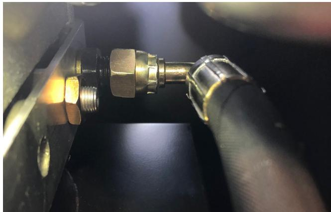
**Bemærk:** Fastspænd omhyggeligt niplen på pumpehuset, inden hydraulikslangen monteres.
