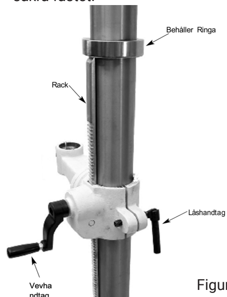
Figur 6 Glid hållarringen över pelaren med den fasade kant nedåt. Positionera ringen mot toppen av ställningen. Säkra ringen med stoppskruv. • Roterar bordsanordningen runt pelaren. Justera ringen som nödvändigt för att förhindra bindning av kuggstängerna. • Koppla vevhandtaget på växelaxeln. • Lås handtaget i hållaren och dra åt för att säkra fästet.
