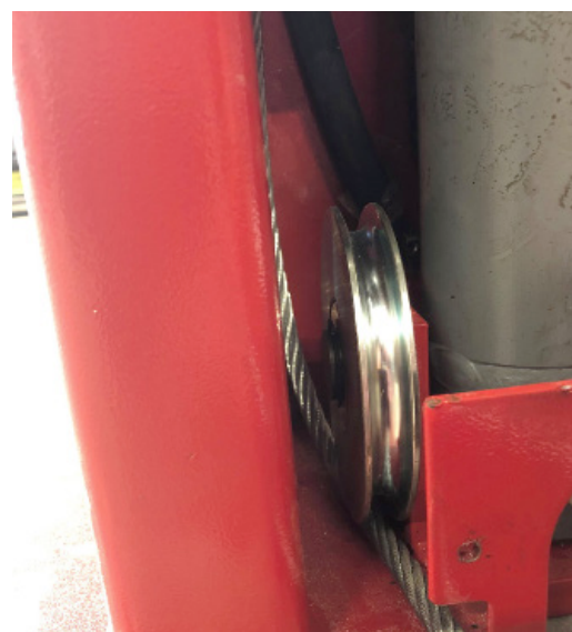
Vri slissen ned mot foten for enklere feste av vaier.
