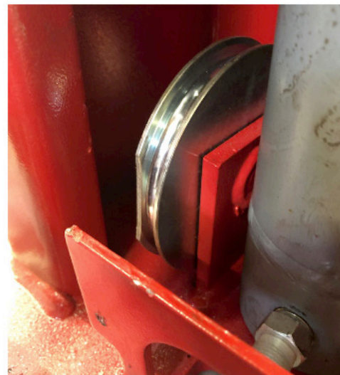
Vri slissen ned mot foten for enklere feste av vaier.
