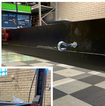
30. Monter koblingen og juster lengden slik at alle sperrer frigjøres samtidig.
