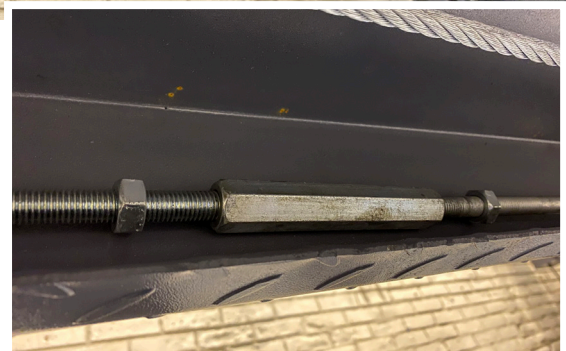
27. Monter akslen til palerne og husk at placere håndtaget der, hvor pumpeenheden er placeret. Indsæt den anden aksel fra den anden side og saml dem på undersiden af rampen.
