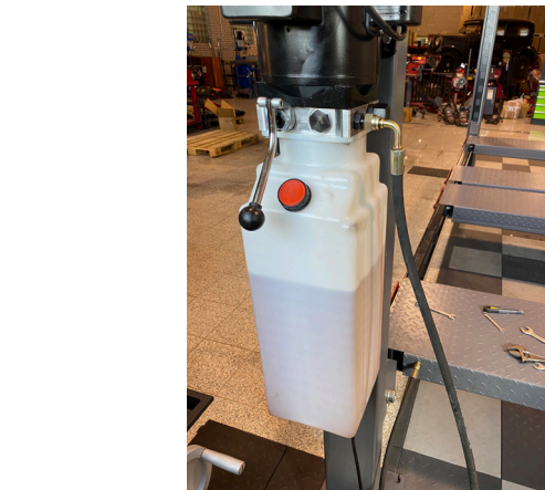
26. Täytä hydraulioöljyä niin, että öljyn pinta on enintään 2–3 cm kannen alla
