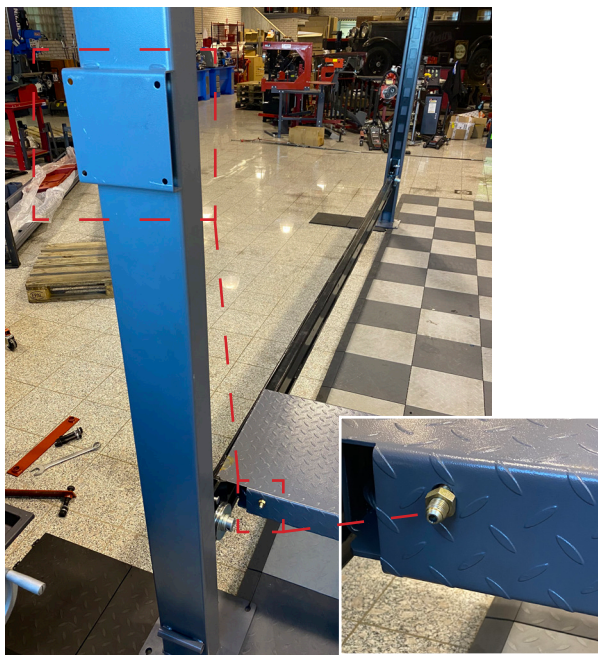
14. Løft med motorløfter eller lignende. Kontroller at hydraulikkoblingen er på samme side som søylen med festet for hydraulikkpumpen.
