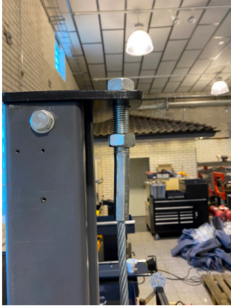
32. Venytä vaijereita niin, että lukitsimet napsahtavat samanaikaisesti rampeja nostettaessa.
