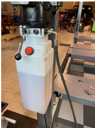
26. Fyll på hydraulikkolje, slik at dent står opp til 2-3 cm under lokket
