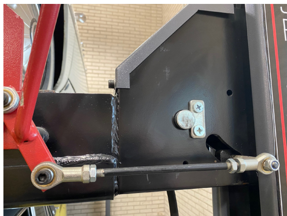
32. Hev løfterampene og legg dem på sperren i samme høyde i alle hjørner. Juster sperretrinnene om nødvendig, og stram deretter vaierne.
