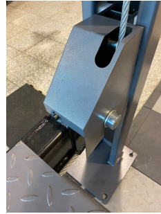
21. Trekk vaieren videre til neste søyle.
