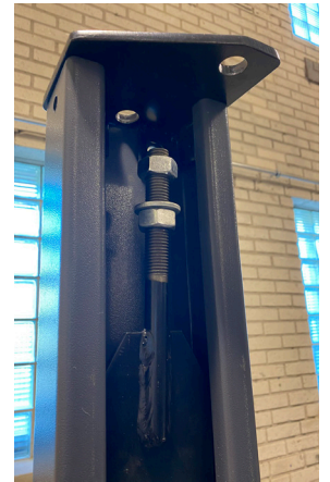
8. Aseta tolppakannet ja tarkista, että vaijerin reikä on yhteensopiva vaijeripyörien kanssa. Kannen alapuolella on oltava myös mutteri ja aluslevy.
