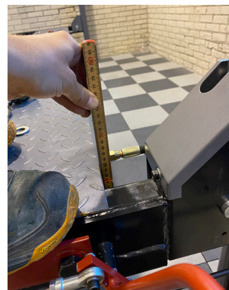
32. Hev løfterampene og legg dem på sperren i samme høyde i alle hjørner. Juster sperretrinnene om nødvendig, og stram deretter vaierne.
