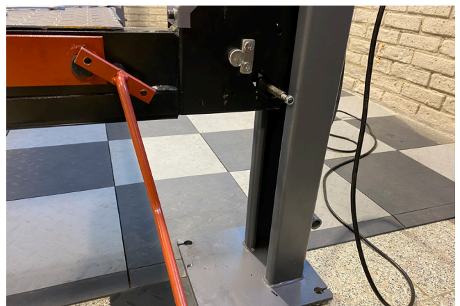
29. Kontroller at posisjonen på leddjernet er den samme i begge ender før du monterer dem.
