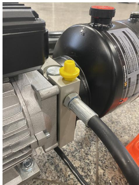
Ta bort den gula pluggen från pumphuset och fäst hydraulslangen. **Kontrollera så att packningen inte sitter fast på pluggen.** Dra åt ordentligt.
