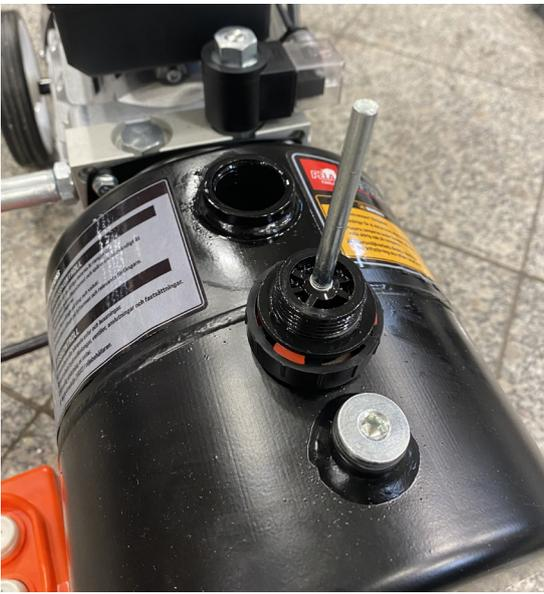
Fyll hydraulikk tanken med ca. fire liter VG32-hydraulikkolje.
