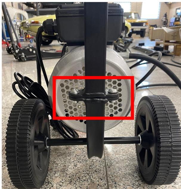
Montera på handtaget med de medföljande två skruvarna, muttrarna och brickorna.
