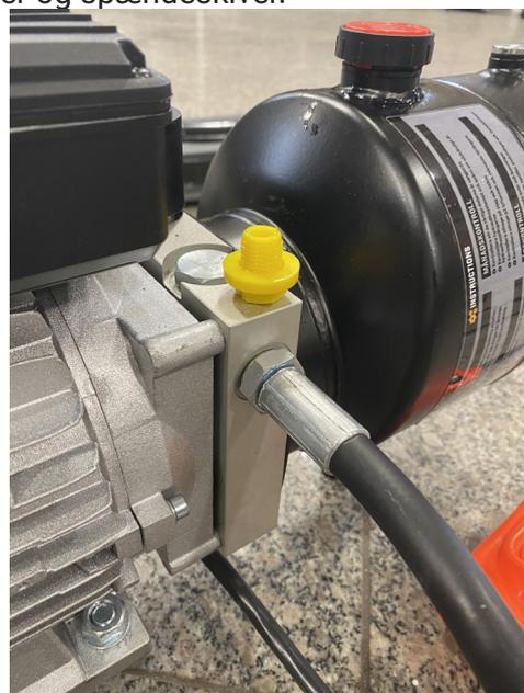
Fjern den gule prop fra pumpehuset og sæt hydraulikslangen på. **Kontrollér, at pakningen ikke sidder fast på proppen.** Spænd godt til.
