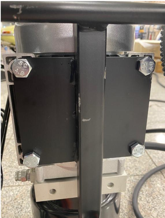
Asenna levy, jossa on pyöräakseli sekä kahvayksikkö, pumppuyksikön taakse. Käytä mukana toimitettuja 4 ruuvia ja mutteria.
