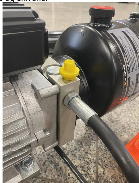
Fjern den gyldne pluggen fra pumpehuset og fest hydraulikkslangen. Sjekk at pakningen ikke sitter fast på pluggen. Stram godt.
