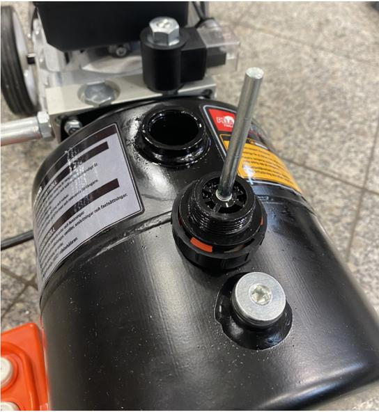
Täytä hydraulisäiliöön noin 4 litraa hydraulioöljyä, VG32.
