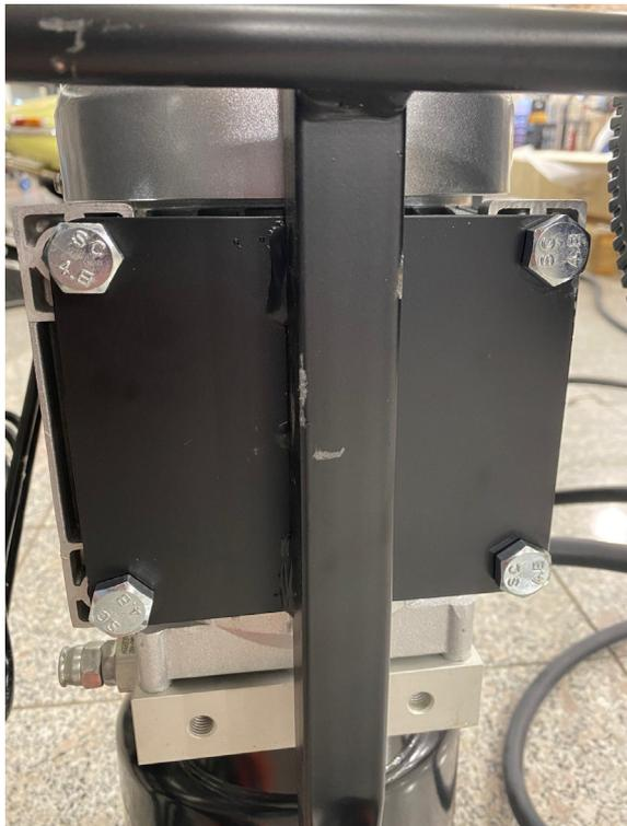
Monter platen med hjulaksel og uttak for håndtak på baksiden av pumpeenheten. Bruk de fire medfølgende skruene og mutrene.
