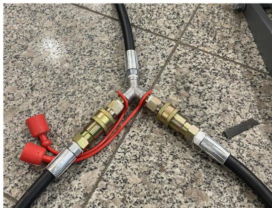
Koppla hydraulslangen till de båda lyftramperna med snabbkopplingarna. **Kontrollera så det sitter ordentligt.**
