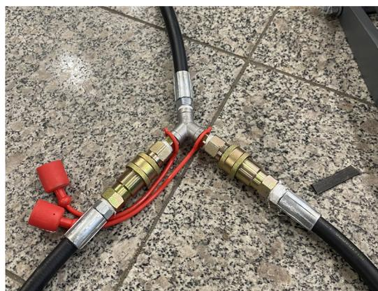
Slut hydraulikslangen til de to løfteramper med lynkoblingerne. **Kontrollér, at den sidder korrekt.**
