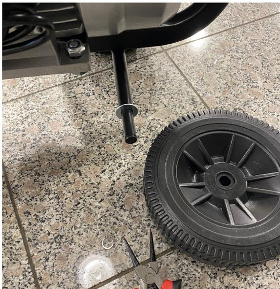
Monter på hjulene. Placer først skiven på hjulakslen og derefter hjulet med den konkave side udad. Fastgør dernæst hjulet med låseringen.
