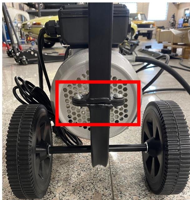
Monter på håndtaget med de medfølgende to skruer, møtrikker og spændeskiver.
