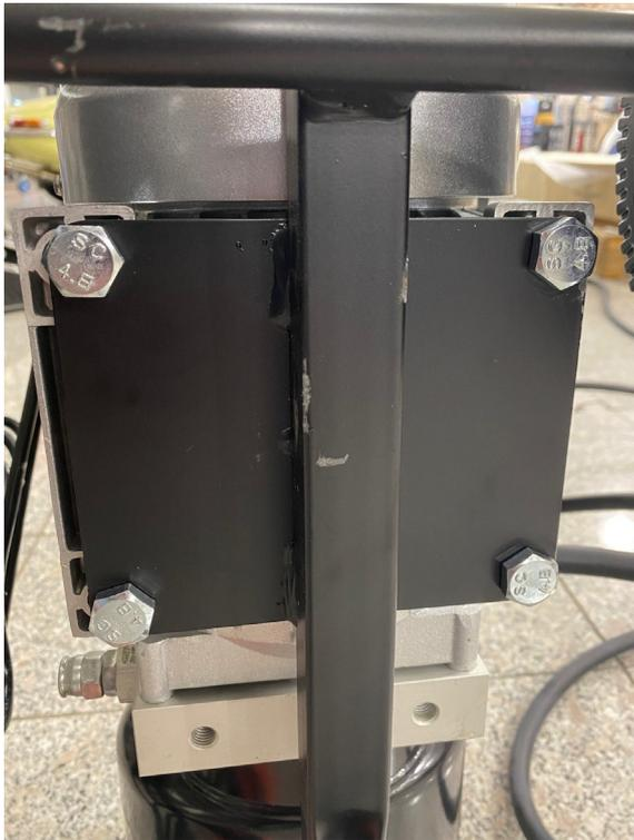
Montera fast plattan med hjulaxel och uttag för handtag på baksidan av pumpenheten. Använd de medföljande 4 skruv och muttrarna.
