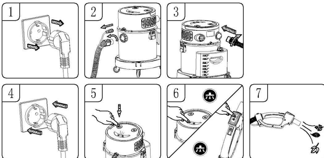
1. Se till att nätsladden är bortkopplad från strömförsörjningen. (Fig 1)
