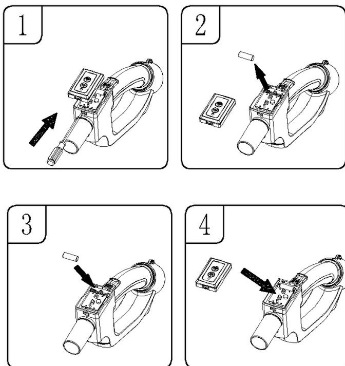
1. Batteridækslet kan åbnes ved at trykke på forsiden af batterirummet med en skruetrækker. (fig. 1)
