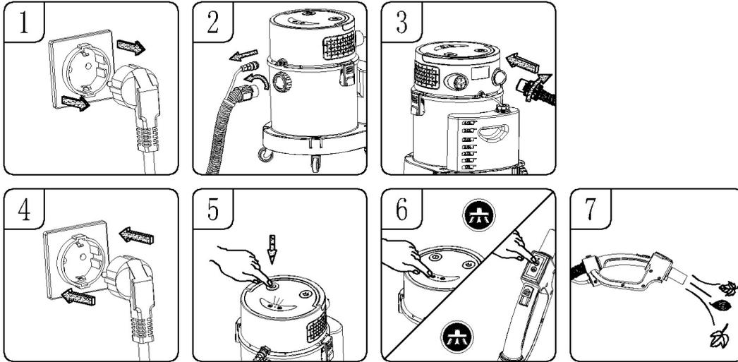
1. Varmista, että virtajohto on irrotettu pistorasiasta. (Kuva 1)
